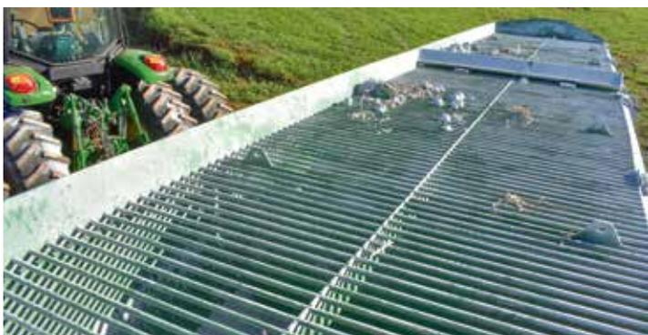
Grades protetoras impedem a entrada de torrões e objetos que possam impedir o funcionamento do sistema
