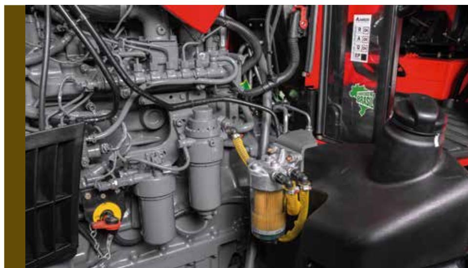
Destacam-se os sensores que monitoram a pressão e a temperatura do óleo
