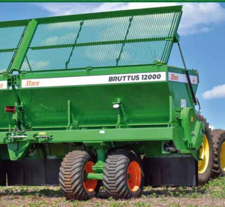
trabalho, as rodas são colocadas no sentido do deslocamento. Os rodados duplos de cada lado foram estrategicamente colocados em posição defasada, um ligeiramente à frente do outro, para proporcionar o funcionamento de um balanço, fazendo o trabalho de rodado em tandem e adaptando-os às irregularidades do terreno.
