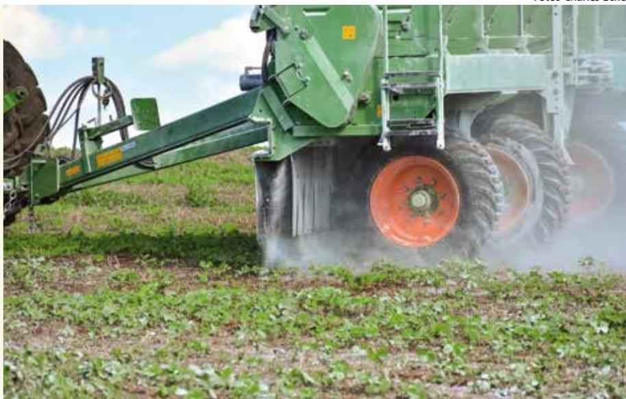
Com a altura de deposição de 1,25m e com o produto passando entre duas cortinas defletoras, a ação do vento praticamente não interfere na deposição
