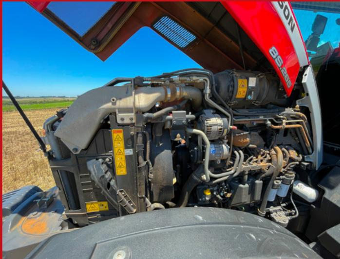
O motor que equipa o Massey Ferguson 8S.265 é um AGCO Power de seis cilindros, com quatro válvulas por cilindro e um turbocompressor variável
