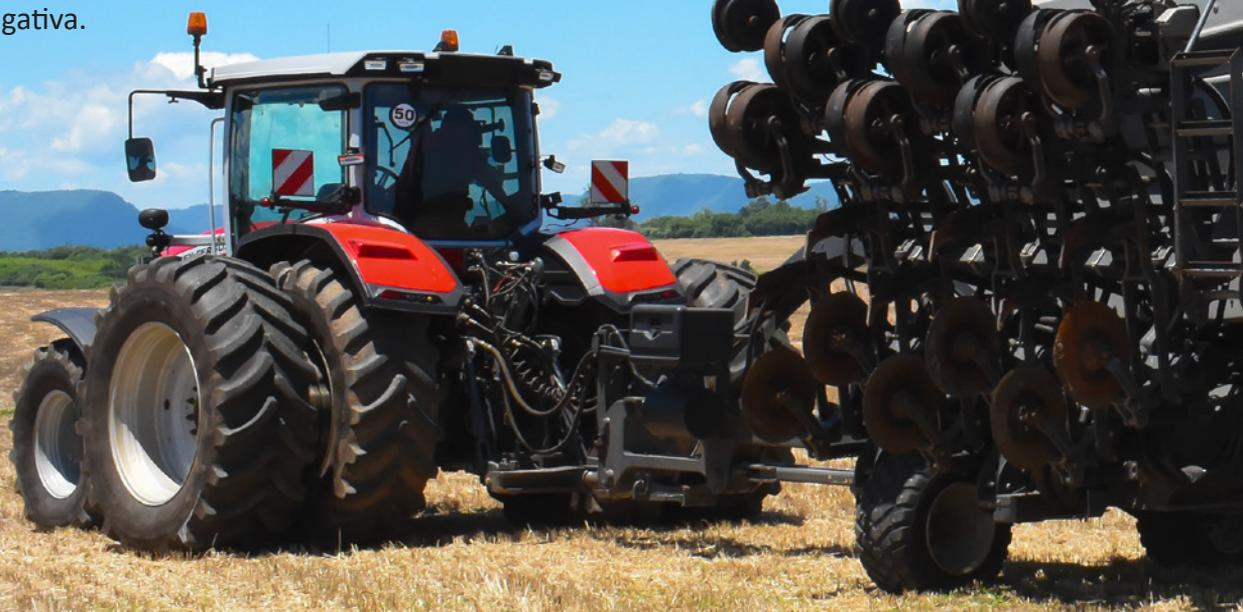
tes, principalmente de abertura dos sulcos. A palha flui entre as linhas, evitando o embuchamento. Também verificamos que a disposição do sistema de posicionamento individual das linhas faz com que elas acompanhem a superfície do solo, adequando-se ao microrrelevo.
