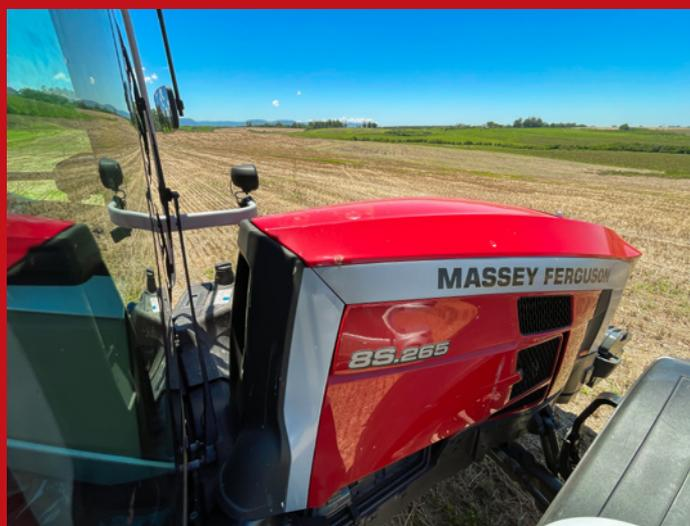
Um dos diferenciais do projeto da Série MF 8S é a separação física entre a cabina e a carenagem do motor, proporcionando um isolamento maior, que diminui ruídos e vibrações no posto do operador
