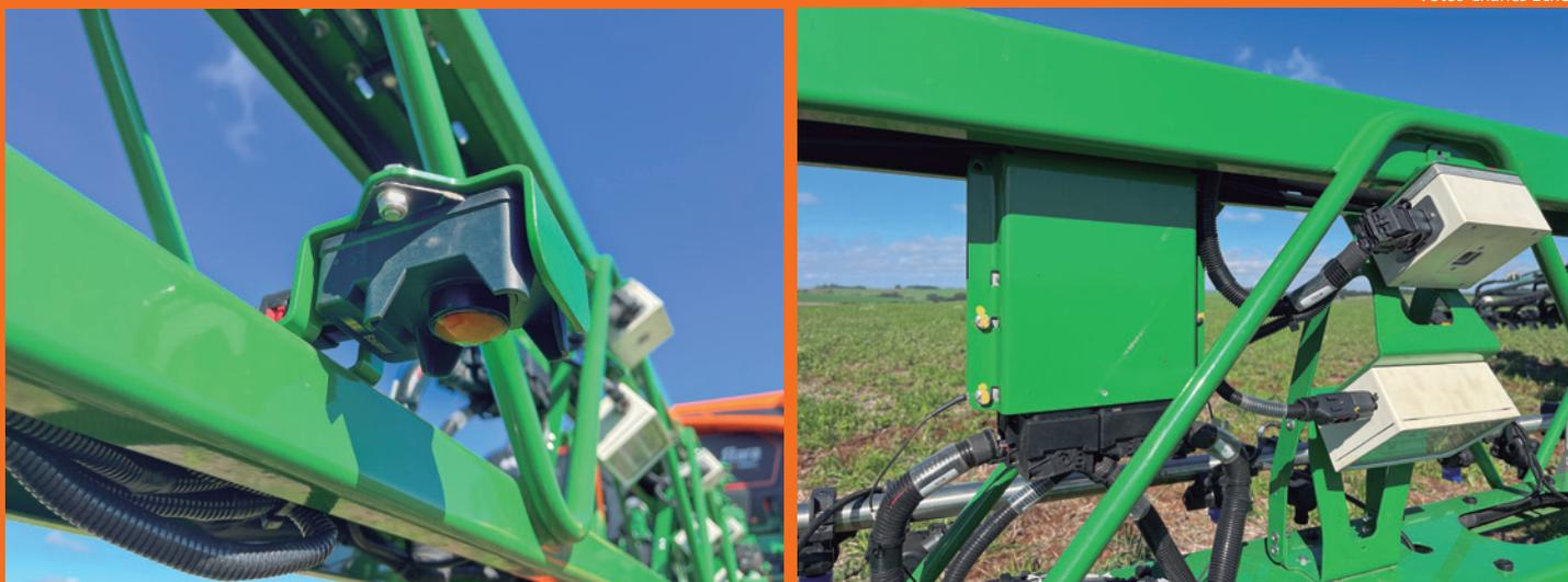
Também fazem parte do sistema, além das câmeras e flashes, sensores ultrassônicos de altura da barra (esquerda) e centrais de processamento distribuídos nas barras
