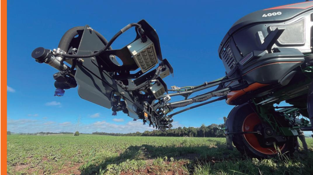
Trinta e um conjuntos de câmeras e flashes estão instalados na barra central e na traseira do Imperador 4000 Eco Spray
