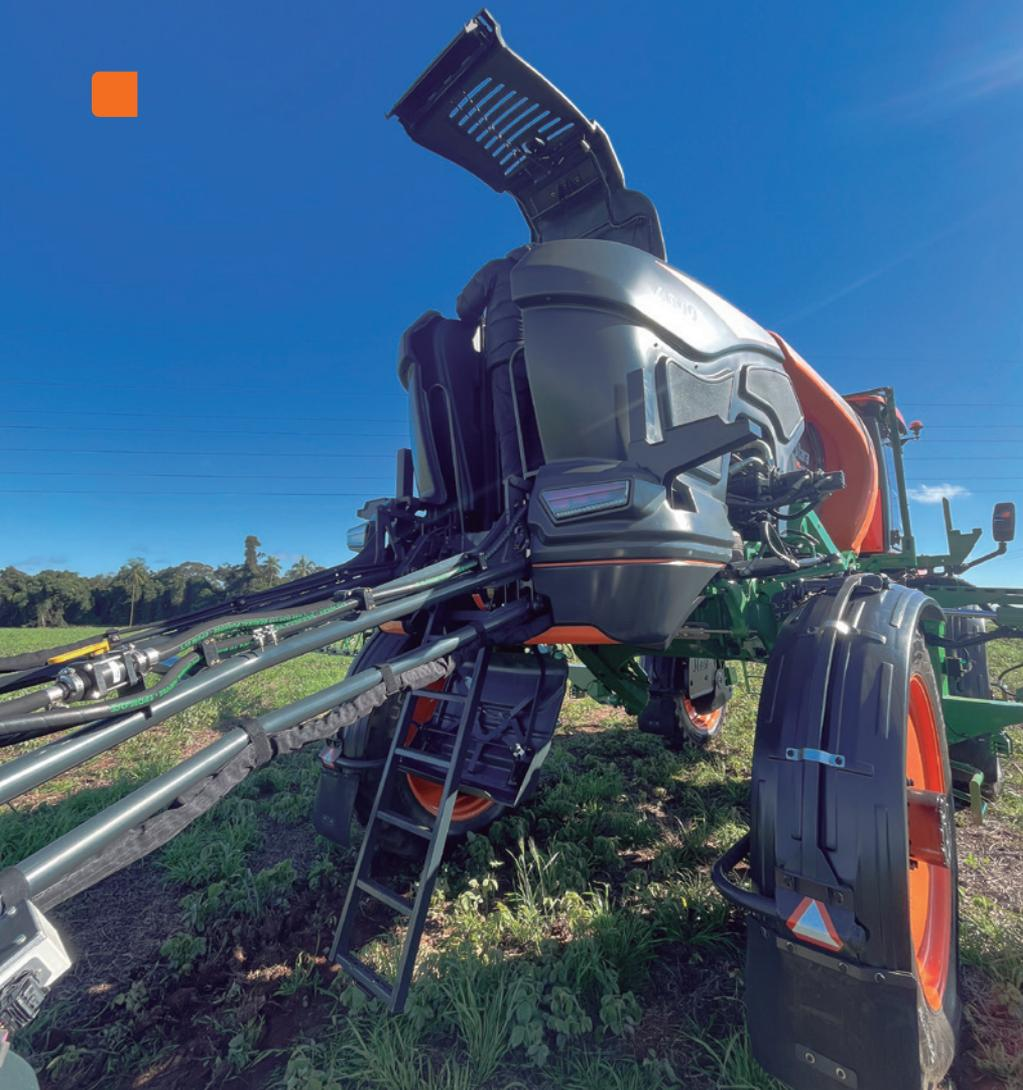
O acesso ao motor e depósitos pode ser feito por uma escada central na parte traseira da máquina
