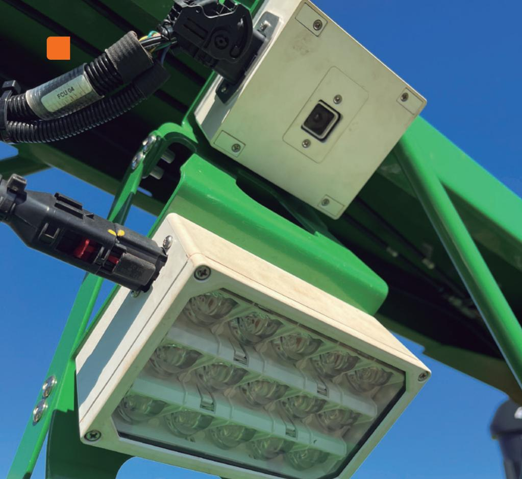
O sistema Eco Spray é formado por câmeras e flashes de LEDs infravermelhos, que refletem a clorofila e permitem que o dispositivo identifique as plantas-alvo
