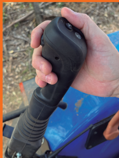
"Joystick" único comanda todas as funções da carregadora frontal e dos implementos acoplados
