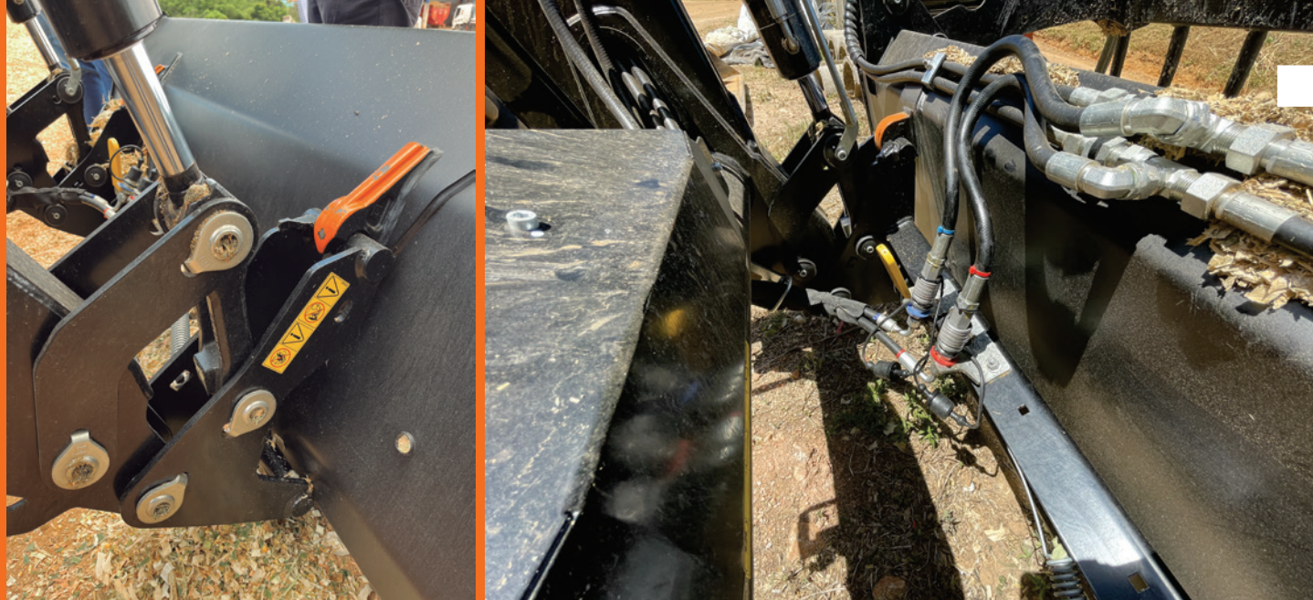
Detalhe do engate rápido (esquerda) e das conexões do terceiro comando (direita)
