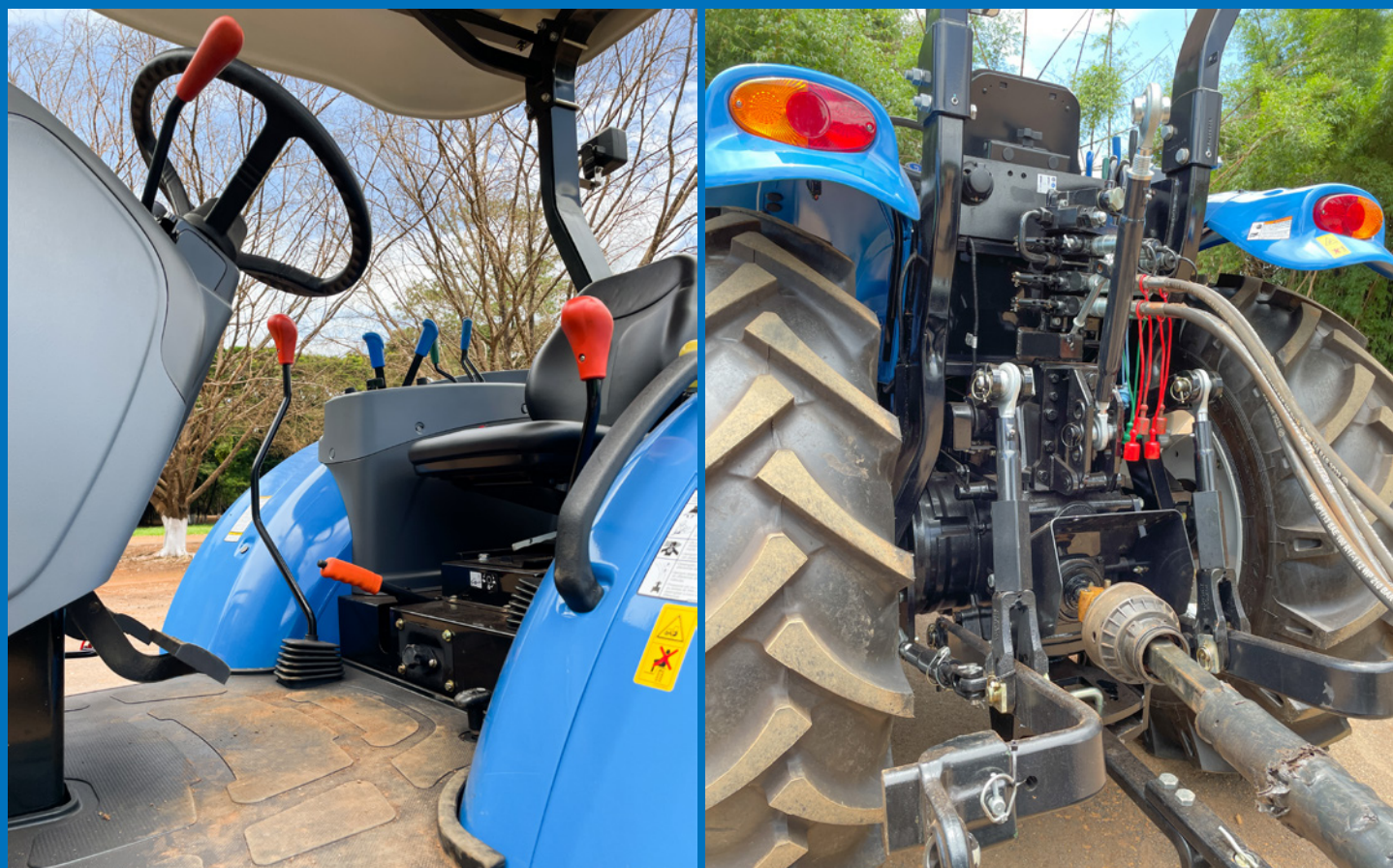
A tomada de potência (TDP) é a tradicionalmente utilizada pela LS, com três velocidades angulares de 540, 750 e 1000 rpm, com opções de TDP econômica
