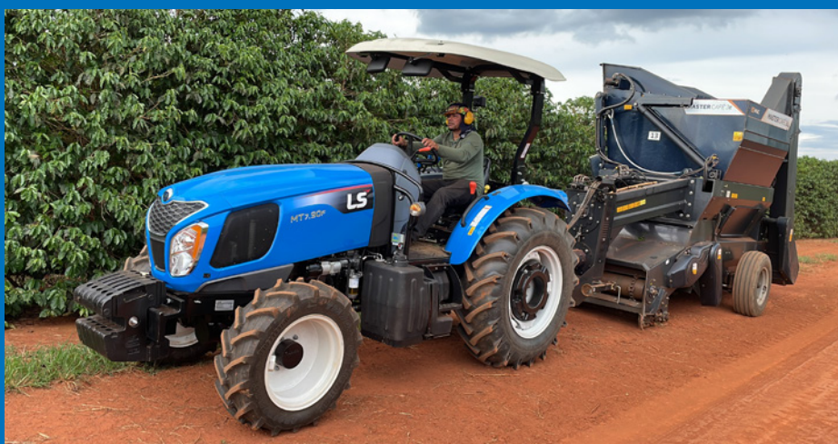
Um dos principais trabalhos do MT7.90F é tracionar a colhedora de café e também a máquina que aspira os grãos caídos no chão após o processo de colheita mecanizada
