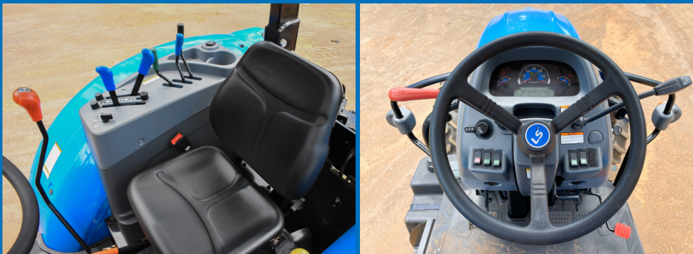
No posto do condutor, a altura do volante e as posições das alavancas de controle e o assento do operador foram reprojctados para garantir melhor ergonomia na atividade onde estes modelos trabalharão
