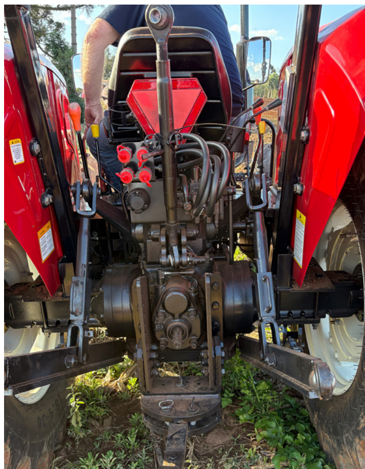
O sistema hidráulico de três pontos é convencional, com os dois braços inferiores dotados de ajuste da folga lateral por meio de tubo telescópico e regulagem do controle de altura em ambos os lados, para facilitar o acoplamento
