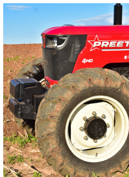
No suporte de pesos do cavalete dianteiro é possível colocar até 12 pesos de 20 kg
