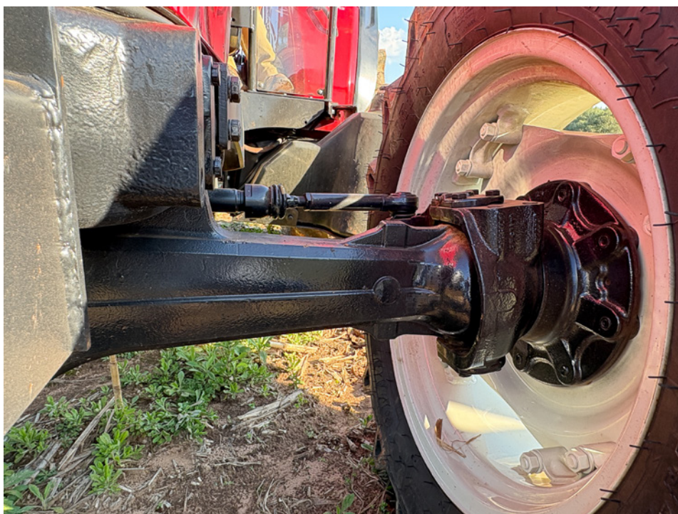
O eixo dianteiro é da tradicional marca Carraro, com acionamento central e com cobertura, para evitar contato com objetos próximos ao chão
