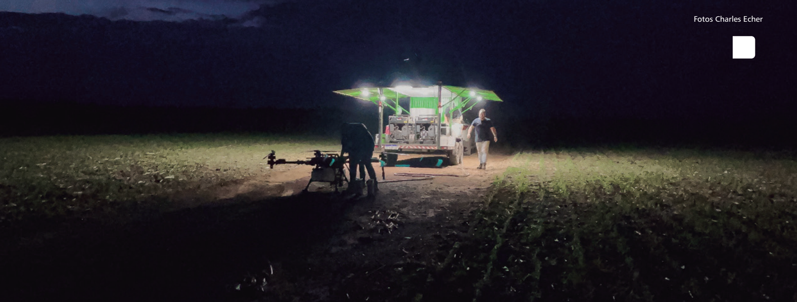
Duas estruturas fixas formadas por um veículo, tipo reboque, continham carregadores de bateria, resfriadores, uma motobomba e plataforma para o piloto
