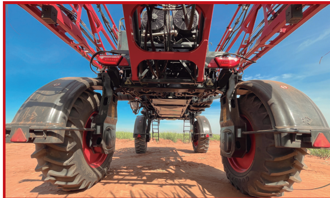
O Avola 3000 tem tração 4x4, com controle eletrônico de tração independente para cada roda, que pode realizar bloqueios em situações onde algum rodado está sem aderência, melhorando o desempenho no deslocamento
