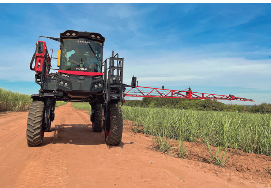
A barra de 24 m a 27 m pode também ser utilizada pela metade, para fazer arremates na lavoura
