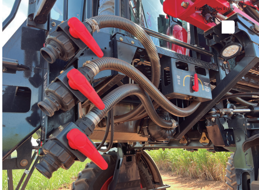
Sistema de abastecimento dos reservatórios de calda e água limpa na parte frontal ao lado da escada. Na lateral, incorporador de produtos e painel de controle do sistema de abastecimento e circulação de produto
