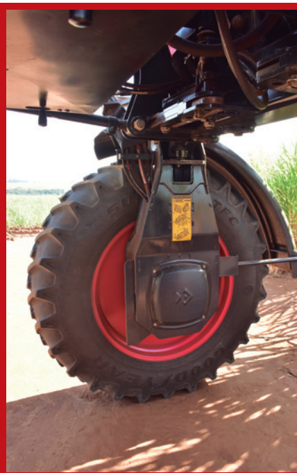
O Avola 3000 tem tração 4x4, com controle eletrônico de tração independente para cada roda, que pode realizar bloqueios em situações onde algum rodado está sem aderência, melhorando o desempenho no deslocamento
