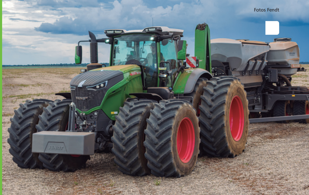
O novo Fendt 1000 Vario Gen4 oferece três versões — 1044, 1048 e 1052 Vario — equipadas com o motor MAN de 6 cilindros e a transmissão VarioDrive de última geração
