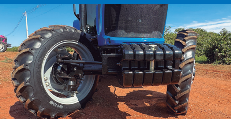
O eixo dianteiro possui bom vão livre e garante um ótimo raio de giro, necessário para atividades em locais com espaço para manobras reduzido
