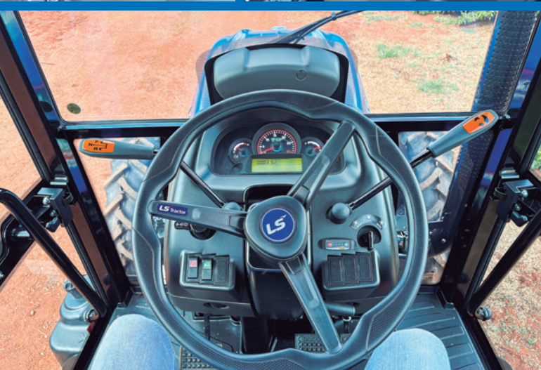
Os principais comandos de transmissão e sistema hidráulico estão distribuídos ergonomicamente nas duas laterais do operador e junto ao volante
