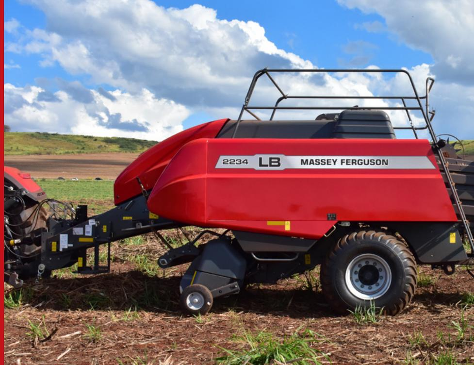
A MF 2234 que testamos produz fardos retangulares de 87,5 cm de altura, 1,20 m de largura e até 2,75 m de comprimento
