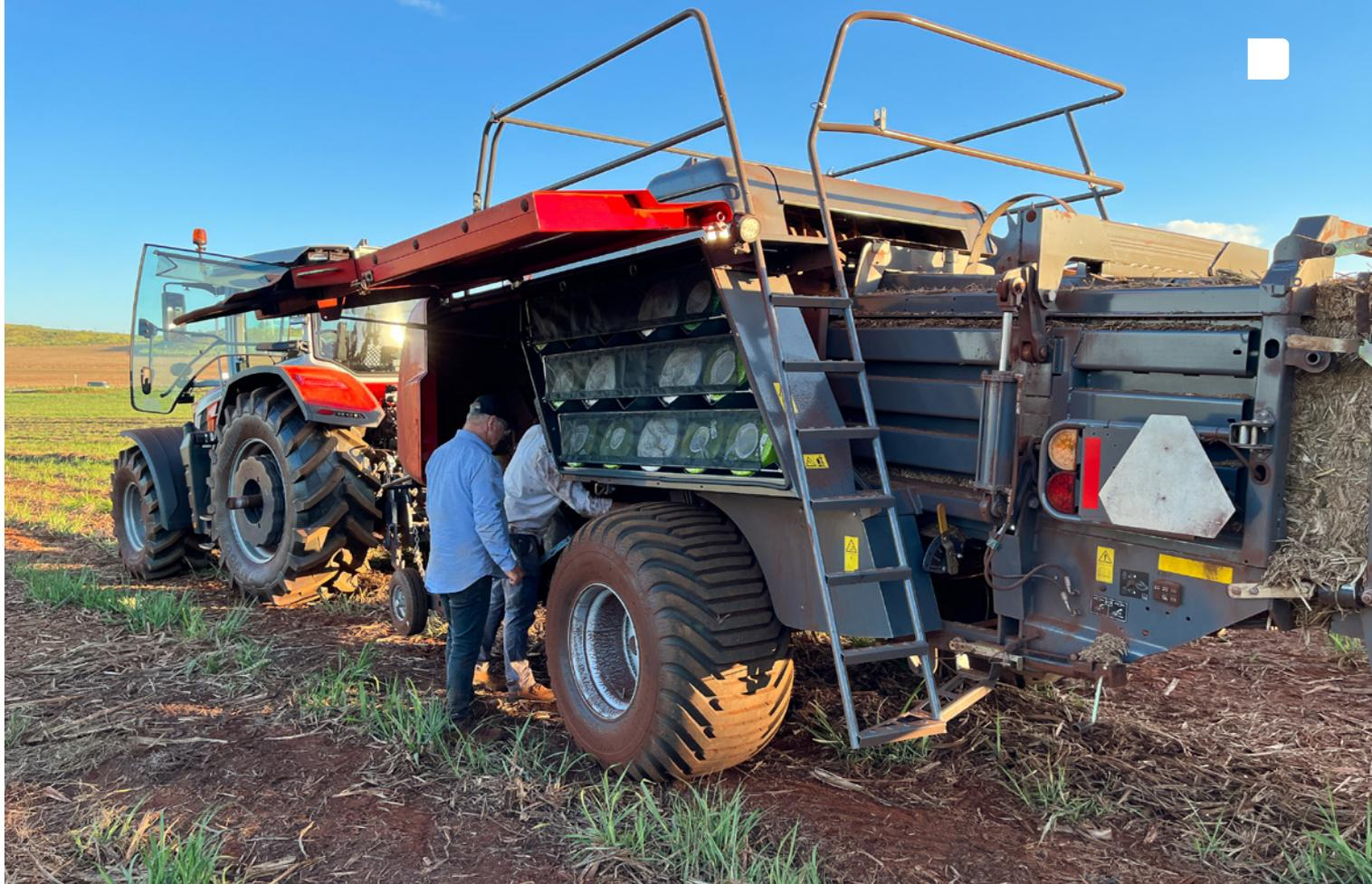
O acesso a todos os sistemas da máquina é facilitado pelo deslocamento total das tampas laterais
