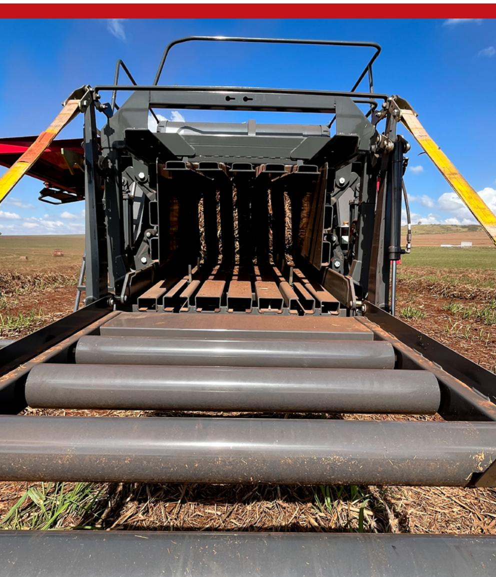
Após a amarração, ganchos conduzem os fardos para uma plataforma com rolos que empurram os fardos para fora da máquina
