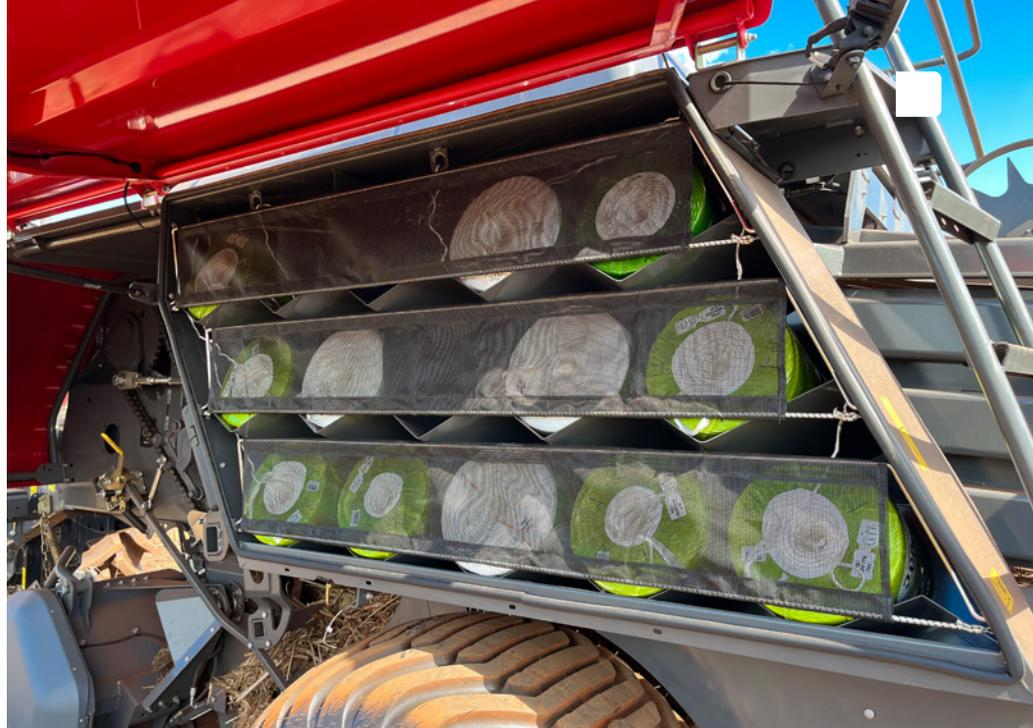
Os fios, armazenados nas laterais tipo colmeia, são de material orgânico ou sintético e possuem um sistema de autolubrificação com óleo, imprescindível para o bom funcionamento
