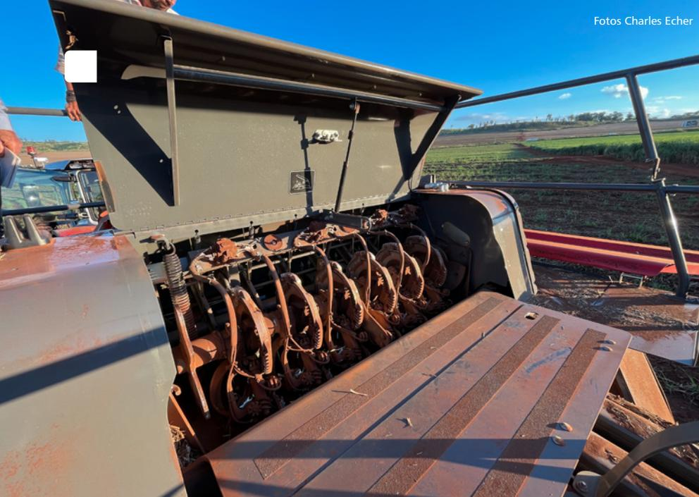
Sistema de amarração dos fardos, composto por seis atadores automáticos que finalizam o processo e deixam o material pronto para ser descarregado no solo
