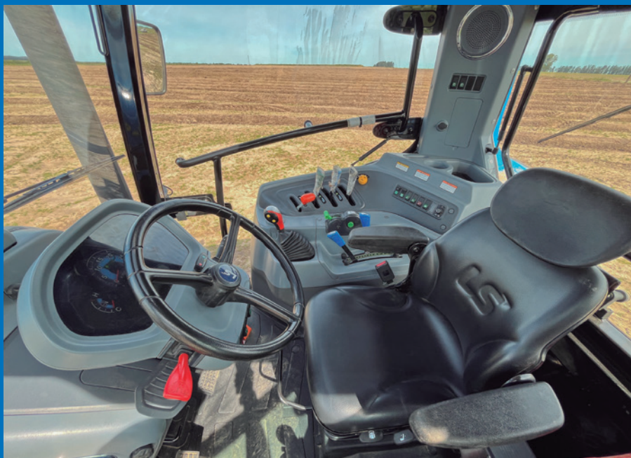
A cabina é amplamente envidraçada, possui duas portas de acesso, console lateral com todos os comandos do trator e teto panorâmico, que proporciona uma visão ampliada
