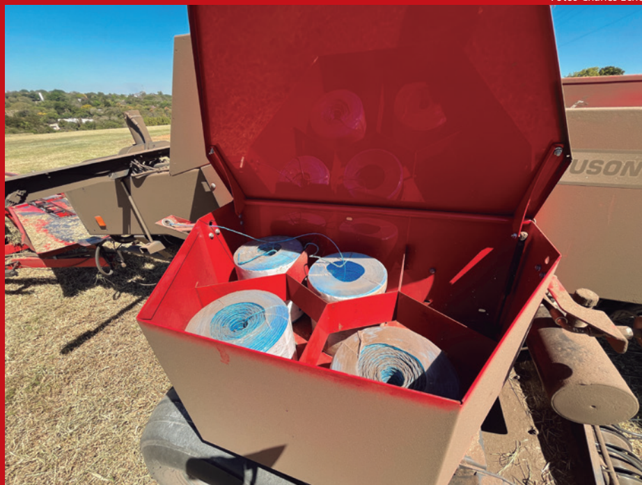
Os fios são armazenados em dois locais na lateral dos atadores com capacidade para até dez bobinas e são emendados de um rolo a outro
