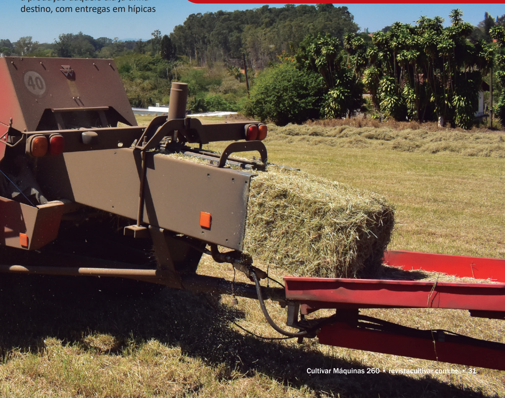
Os fios são armazenados em dois locais na lateral dos atadores com capacidade para até dez bobinas e são emendados de um rolo a outro
